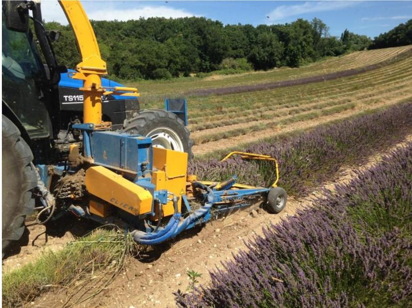
Les deux barres jaunes fixées à l'avant du cueilleur effleurent les lavandes et permettent ainsi aux abeilles de s'envoler avant le passage du rotor.
